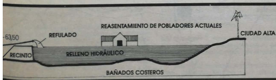
▼ 7 Corte esquemático de la solución técnica de relleno por refulado
